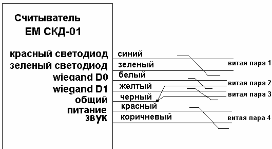
Рис. 5. Подключение считывателя с использованием витых пар.
