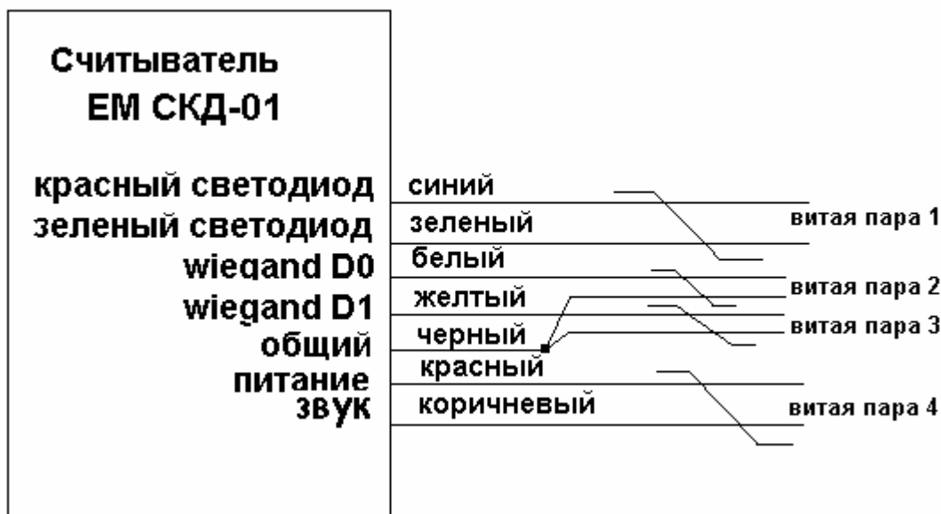
Рис. 5. Подключение считывателя с использованием витых пар.
