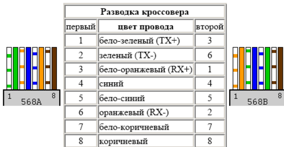
Рис. 6. Разводка кроссовера
