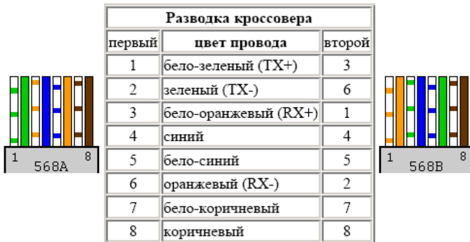
Рис. 4. Разводка кроссовера
