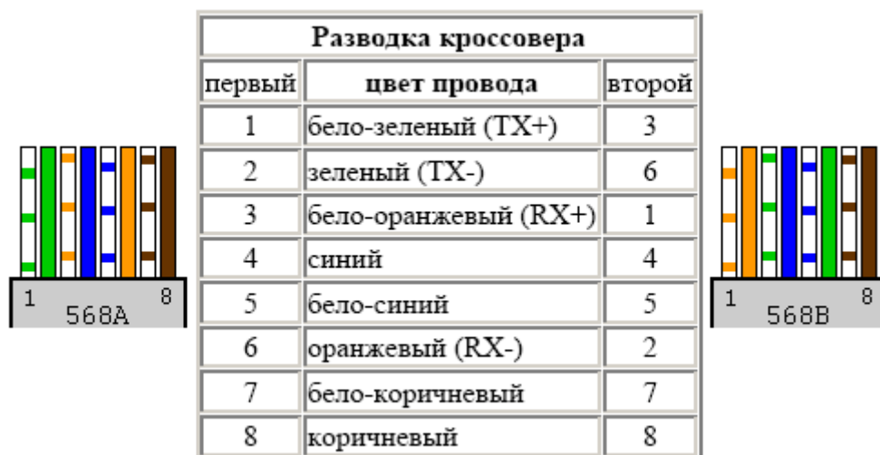
Рис. 4. Разводка кроссовера
